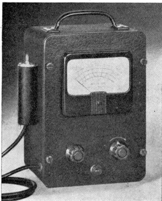
Fig. 9.15. — Aspetto esterno del voltmetro a valvola di fig. 9.13.
