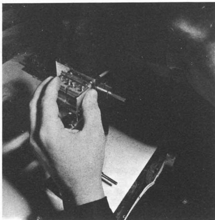
*Il condensatore variabile deve essere maneggiato con cautela, per evitare che eventuali urti possano danneggiare il giuoco delle lamine mobili dentro quelle fisse, compromettendo l'intero sistema di isolamento.*
