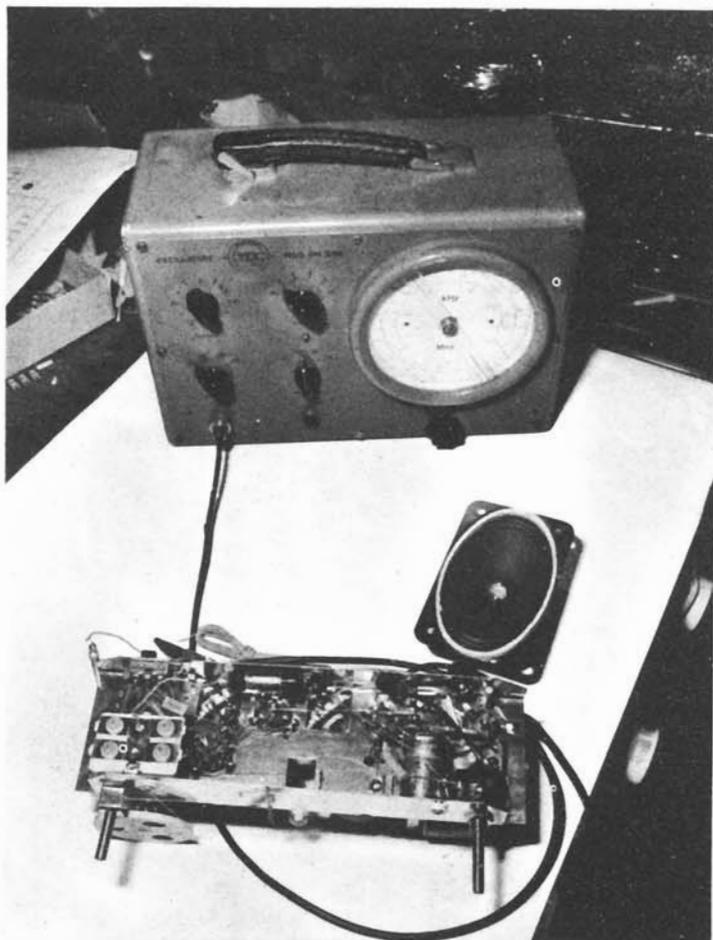
*Le operazioni di taratura vanno iniziate soltanto dopo aver completato l'intero montaggio e dopo essersi accertati del funzionamento del ricevitore.*
