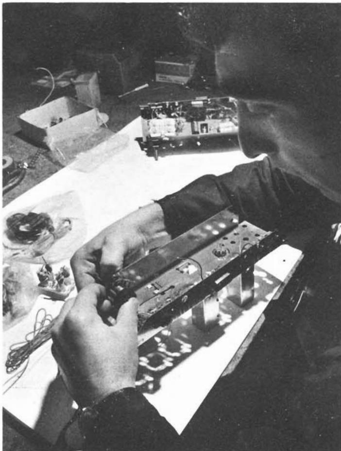
*Il potenziometro, che regola il volume sonoro del ricevitore radio, e nel quale è pure incorporato l'interruttore generale dell'intero circuito, viene applicato al telaio per mezzo di un dado e, alle volte, di un controdado.*
