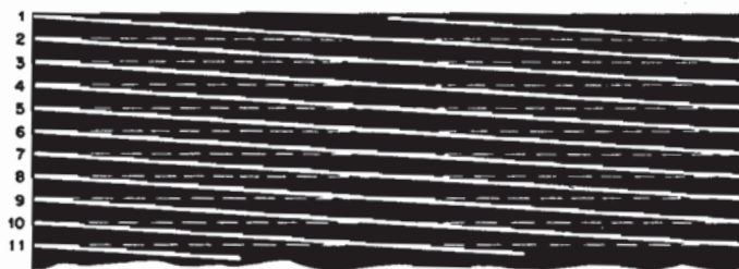
Fig. 3.1. - Le righe dello schermo TV.
