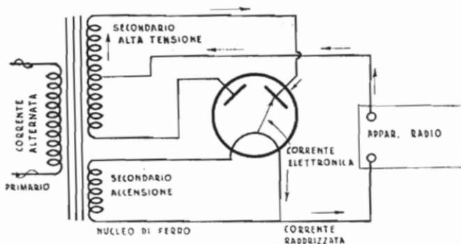
Fig. 140. - Principio di funzionamento della valvola raddrizzatrice bipacca.
