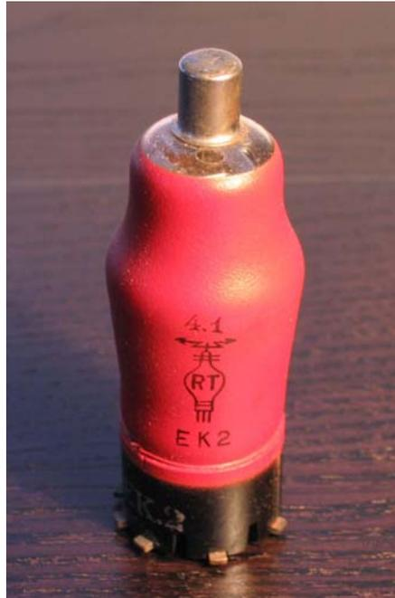
Gli ottodi hanno 6 griglie. La prima griglia (g1) è la griglia della funzione oscillatrice ed è chiamata appunto griglia oscillatrice. La seconda griglia (g2) svolge la funzione di anodo per l'oscillatrice ed è infatti chiamata “griglia anodica”.
