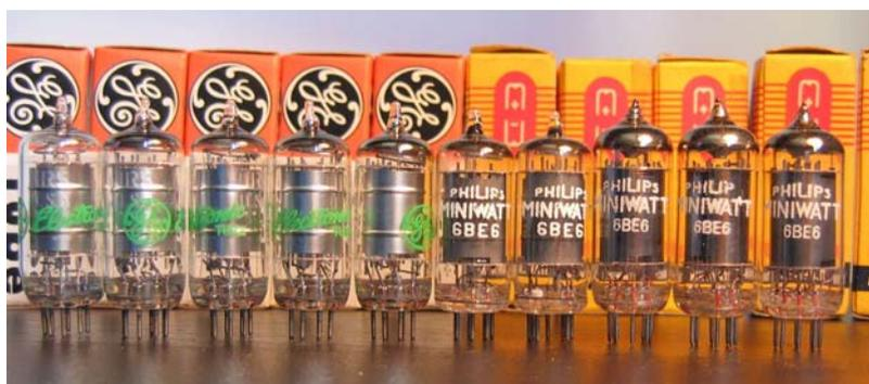
Anche in queste valvole il fenomeno della conversione di frequenza avviene per mezzo di una doppia modulazione della corrente elettronica emessa dal catodo: una prima modulazione è rappresentata dal segnale dell'oscillatore locale, mentre la seconda, dal segnale RF da convertire.
