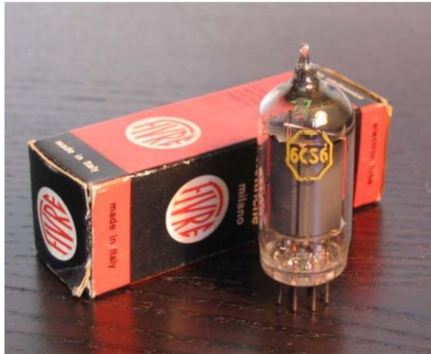
Non si tratta di convertitrici di frequenza per applicazioni radio, ma di valvole con doppio controllo. Cioè le due griglie g1 e g3, agiscono in uguale maniera sulla conduzione del tubo, e non hanno la caratteristica a pendenza variabile. Sono adatte come separatrici di sincronismo per televisione o per applicazioni speciali e le ho volute inserire solo per completezza di informazione. La valvola E91H era prevista per lavorare nei circuiti dei computer a valvole degli anni 60.
