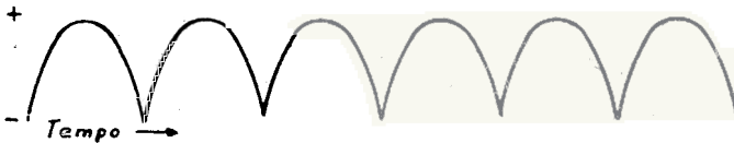
FIG. 57 - Uscita di un rettificatore ad onda completa senza filtro.
