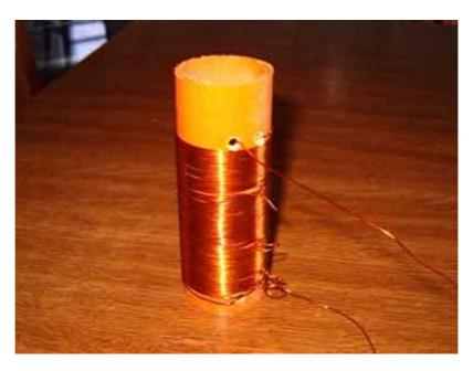
Misurate con l'induttanzimetro digitale il valore della bobina. 131 microhenry. FANTASTICO !!! Avete realizzato una bobina dallo 0,8% di tolleranza. Sappiate che le bobine commerciali hanno anche il 10% di tolleranza.
