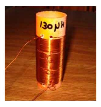
Con un cutter "grattate" le prese in modo da rendere nudo il rame e prestagnate con il saldatore. In questo modo i collegamenti saranno possibili.
