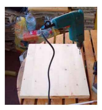
Bene, a questo punto dovete eseguire una operazione **di precisione**. Bisogna forare il pannello anteriore in modo che il perno della sintonia (barra filettata) lo attraversi.
