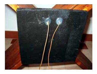
Adesso create i collegamenti. Procurate 4 spine a banana. Create due cavi lunghi circa 5 mt. ognuno con ai capi due spinotti. Il cavo serve per il collegamento della radio all'antenna.
