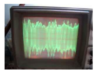
Terza prova: puntali tra **catodo** diodo e massa. **Presenza** di portante.Notate il segnale BF rivelato.
