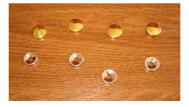
Acquistate quattro rondelle di gomma. Serviranno a fissare l'altoparlante al pannello anteriore e ad ammortizzarlo.
