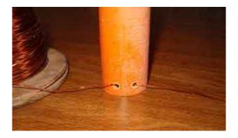
Iniziate a passare attorno al tubo il filo con molta calma, creando delle prese alla spira n. 3 - 10 - 30 - 60. Queste prese serviranno per provare i vari gradi di selettivita' della radio, sapendo che piu' la presa si trova vicino a massa piu' la ricezione sara' selettiva ma meno amplificata.
