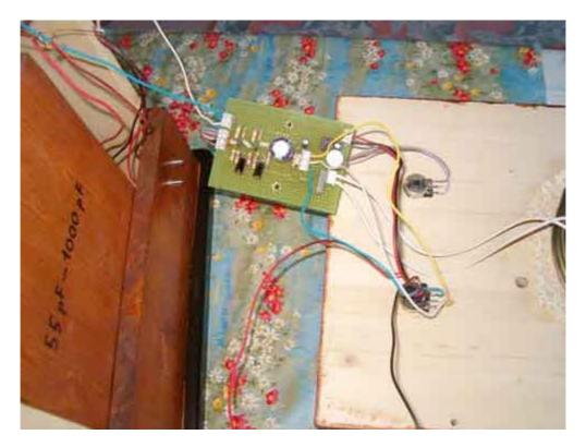
Avvitate sul telaio interno il circuito.
