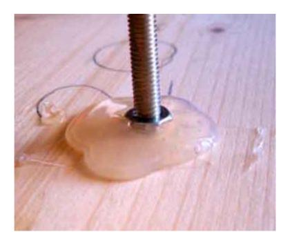
Per evitare che la barra filettata, quando gira tocchi direttamente la lamella basculante, generando qualche interferenza, si incolli con Attak un pezzo di plastica isolante nel punto in cui la stessa barra filettata tocca la lamella.
