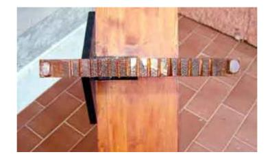
Cominciate a passare con molta cura il filo elettrico attorno la struttura, nelle tacche create, in modo da creare un grosso solenoide di 14 spire. Prestate molta cura al design, in quanto l'antenna costituira' anche un elemento ornamentale e di arredamento. Se avete rispettato le misure, occorreranno circa 40 mt. di filo elettrico.
