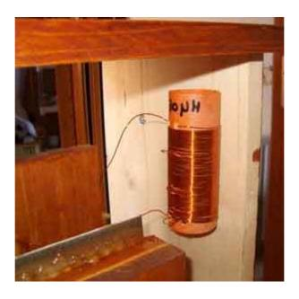
Accorciate i fili della bobina e del condensatore variabile e collegarli tra loro in parallelo. Il filo della bobina e' smaltato pertanto occorre scorticarlo un po' con il cutter.
