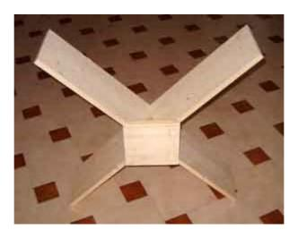
Nella intersezione delle due tavole dovete incollare quattro piccoli zoccoletti di rinforzo (per tutti i quattro lati).
