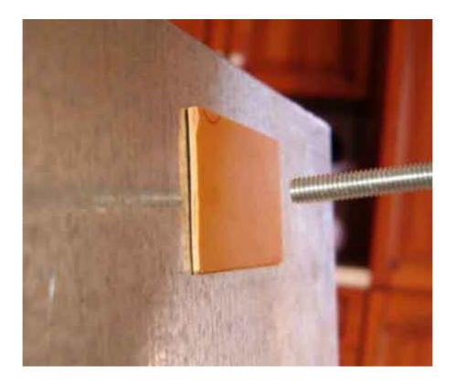
Occorre adesso praticare dei fori alla base del condensatore variabile, che serviranno in seguito al fissaggio mediante viti al mobile. I fori sono dal diametro di circa 4-5 mm.
