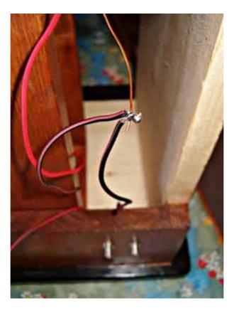
Il filo rosso della presa a banana andra' saldato sul lato caldo del parallelo LC, interponendo' per' un condensatore ceramico da 10 pF.
