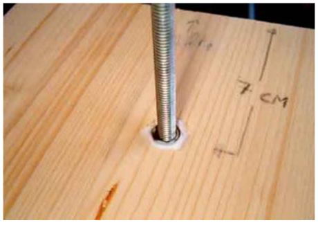
Il bullone appena inserito e' insufficiente, poiche' la barra filettata bascuola troppo su se stessa. Si provveda allora a fissare un secondo bullone dalla parte interna, stavolta usando la colla a caldo.
