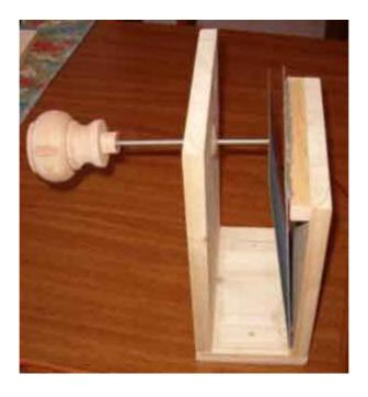
Misurare il valore del condensatore variabile. Con un frequenzimetro digitale avrete i migliori risultati. Avete ottenuto un condensatore variabile con range d'azione che va dai 55 pF minimi ai 1.000 pF massimi. Un ottimo risultato!!!
