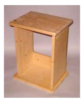
Dopo circa 24 ore di incollaggio si provveda a dare una profonda scartavetratura all'intero mobile in modo da renderlo molto liscio.
