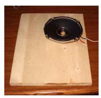
Piazzatelo perfettamente al centro sul pannello nella parte bassa e tracciate il contorno e i 4 fori delle viti. La posizione dell'altoparlante non e' critica.
