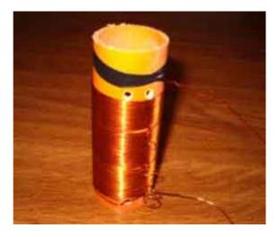
Adesso si puo' passare il filo attraverso i due fori. E' molto piu' semplice. Togliete il nastro adesivo e ammirate il vostro capolavoro. Realizzare bobina e' un'opera d'arte.
