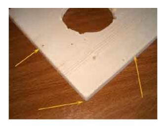
Create due fori per ospitare in seguito i potenziometri. Il foro deve essere esattamente largo quanto la filettatura del potenziometro per permettere una sicura avvitatura dello stesso. I due fori disteranno 7 cm. dall'alto e saranno centrati a 10 cm. distanti tra loro.
