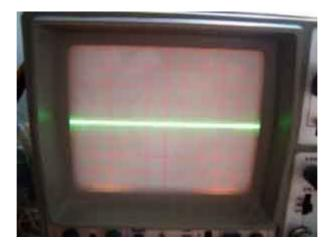
Seconda prova: puntali tra anodo diodo e massa. Presenza di portante.
