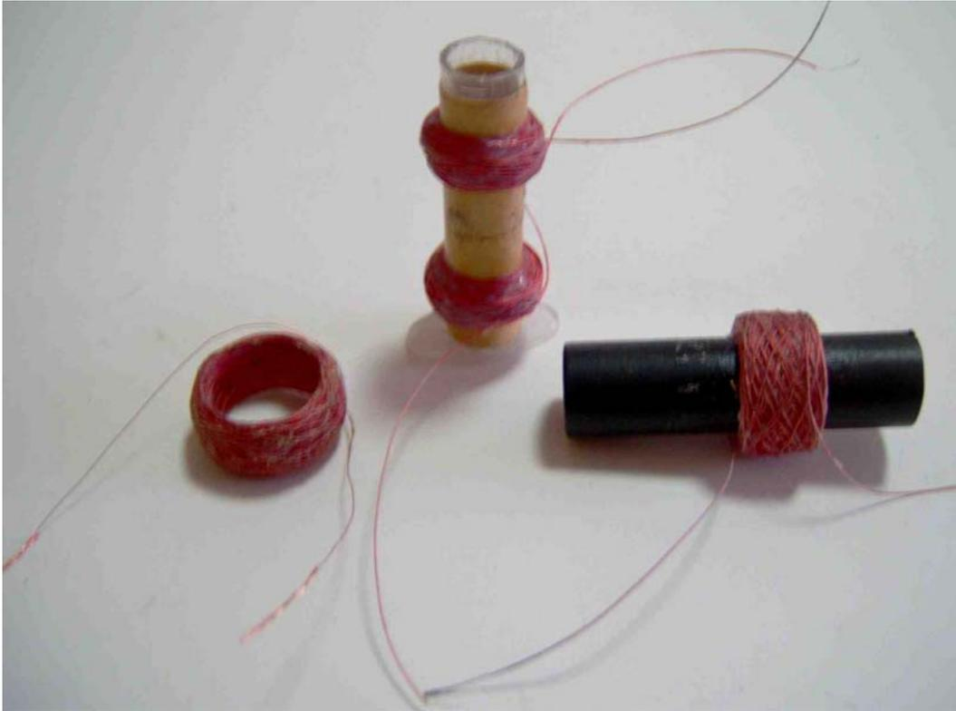
Ed ecco le prime “creature” prodotte, si noti al centro una prova di “Media Frequenza”, avvolta su una siringa da 3 ml, privata dello stantuffo e segata in cima. Appena avrò tempo e voglia farò le dovute prove per accoppiare i condensatori ed i compensatori di taratura.
