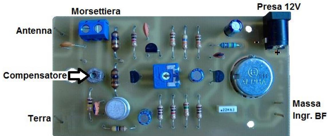
Naturalmente, per accedere all'interno del TX occorre svitare la vite di fermo del suo coperchio. Non bisogna, assolutamente, ruotare il trimmer che è stato tarato in origine per il corretto funzionamento dell'apparecchio. Questo è facilmente individuabile: è l'oggetto quadrato posto al centro del circuito, di colore azzurro con la vitina plastica centrale di colore bianco.
