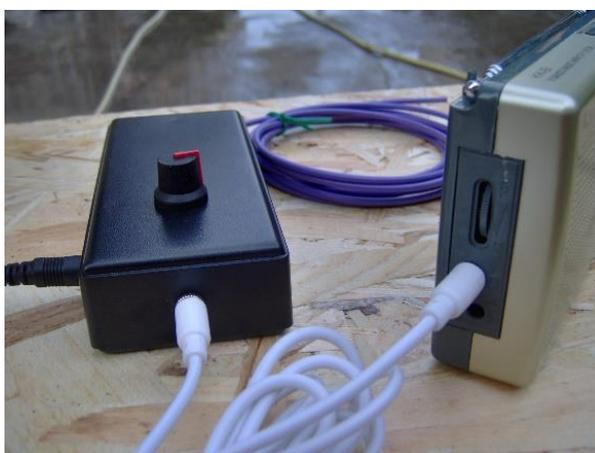
Normalmente la presa jack d'uscita audio si trova sul fianco o sul retro del mobile della radio e si identifica facilmente perché contrassegnata dal simboletto delle cuffie. L'altra presa, se presente, serve per il collegamento con un alimentatore da rete esterno (al posto delle batterie).
