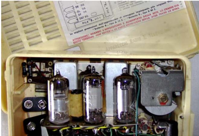
Fig.04. Le valvole del Superdinghy
