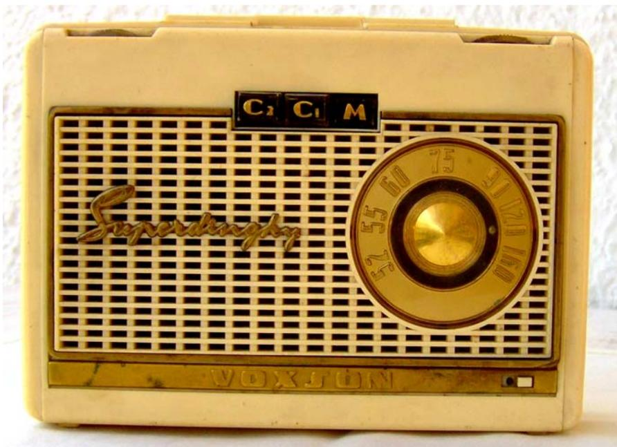
Fig.06 Il Superdinghy. In basso è il deviatore Alta e Bassa potenza.
