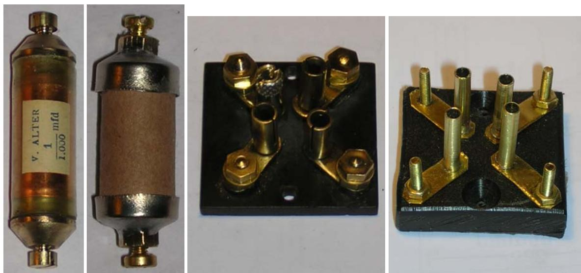
Fig. 3. Condensatori fissi e zoccoli per le valvole. Originali e repliche.
