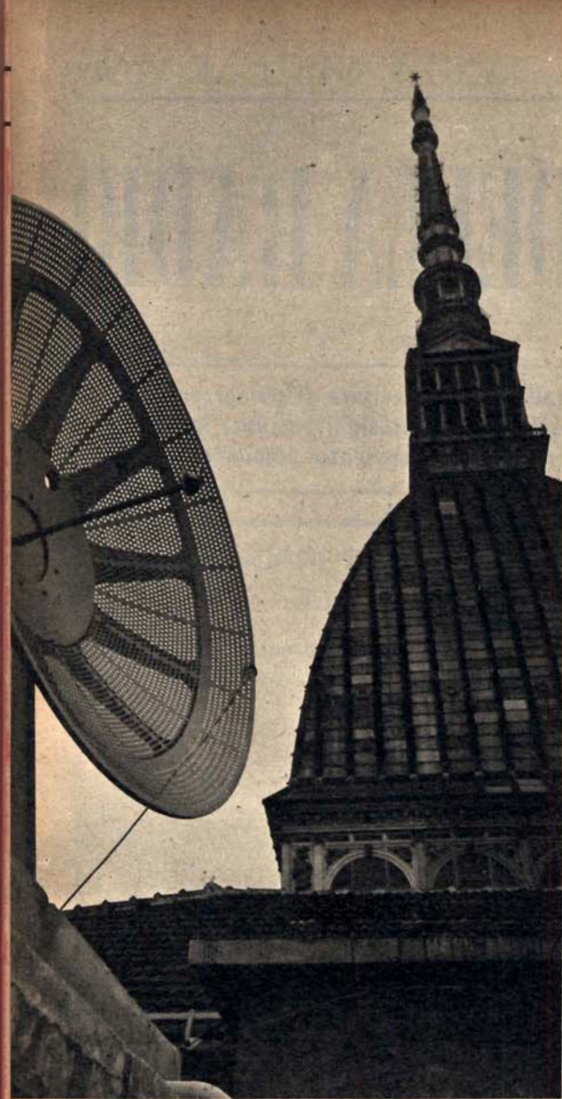
La stazione radio di Torino ha già sperimentato felicemente la televisione. Questa scodella è un sistema irradiante e ricevente per ponti radio.
