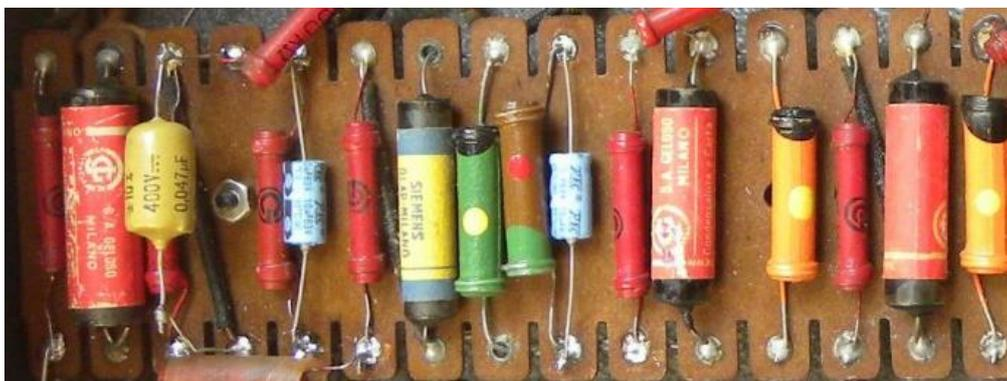
Lo scopo però è quello di fare un intervento conservativo che permetta non solo di ottenere un apparecchio riparato e funzionante ma anche di preservarne l'aspetto originale. Nella foto che segue si vede il risultato finale, ovvero i condensatori moderni inseriti negli involucri ricavati dalle siringhe, chiusi con i gommini e rietichettati grazie all'uso del noto e già citato programma di fotoritocco.
