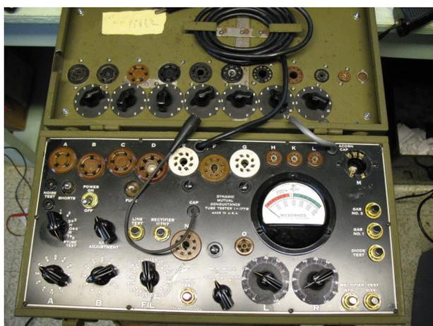
FIGURA 2 - Uno Hickok I-177 modificato come proposto dall'articolo [1] di Bradley: in alto è ben visibile il secondo coperchio sovrapposto al coperchio originale; in basso si può osservare la nuova serie di zoccoli e di manopole per la regolazione dello strumento. La graduazione delle manopole L ed R è stata portata su una scala 0 - 100.
