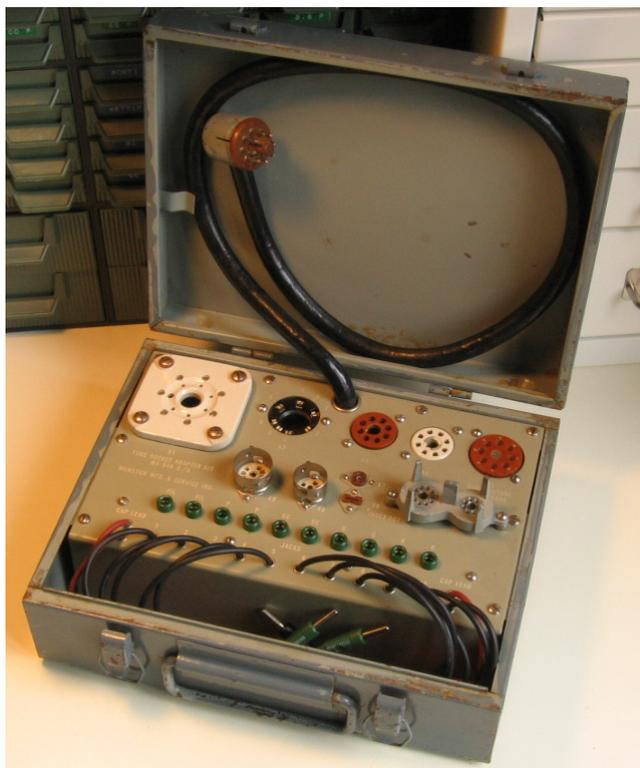
Figura 4 – La scatola d'espansione Hickok modello MX-949\U. È ben visibile la fila di boccole e di spinotti con cui è possibile combinare a piacere le piedinature. Nel coperchio, il connettore Octal di collegamento al provavalvole I-177.
