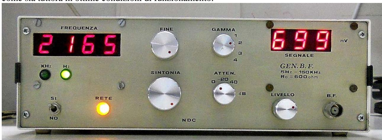
Nella foto la versione definitiva del generatore B.F. costruito tanti anni fa ed ancora in ottimo stato di servizio. Ora sta generando 699mV di segnale a 2165Hz.
