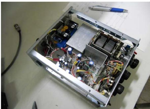
E' mostrata la versione finale del distorsiometro con capacità variabile.
