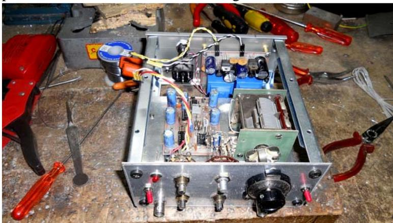
Il distorsiometro in una prima fase di montaggio con il variabile appoggiato e messo in asse con la demoltiplica per determinare la foratura di fissaggio ma non ancora completo né collegato al circuito.
