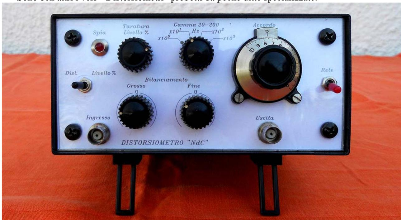
Foto dello strumentino che contiene il filtro arresta-banda. Il contenitore ha le dimensioni di 80x170x200mm e porta il N°50/2000 sul catalogo di una nota ditta italiana di componentistica (Catalogo 2008)
