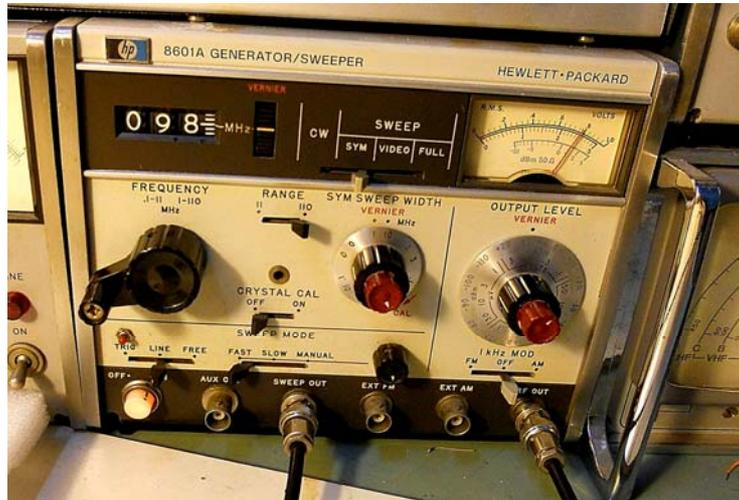
Il generatore è sintonizzato su 98MHz (Range 110), in modo Sweep-Sym-Fast-Line, senza F.M. (Mod: OFF).
