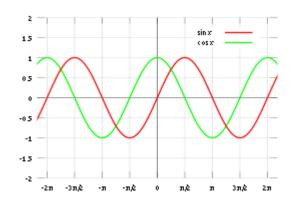
Sinusoide e cosinusoide, oppure due onde sfasate di  $90^{\circ}$
