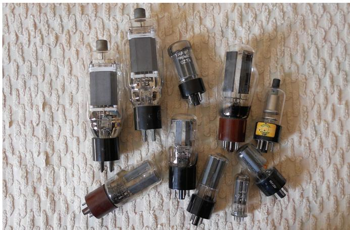
Alcuni tipi di diodi raddrizzatori. In alto, da sinistra: due 1616, una GZ34., una 5X4, una 1B3 per E.A.T. In basso: una 5Y3, una 5V4, una 5V4GT, una EZ41, una 5Y3GT. Diodo significa due vie (dal greco). Le 1616 sono raddrizzatrici A.T. (5500V- 0.13A-0,8Amax) con l'anodo di grafite.
