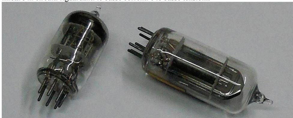
A destra un doppio diodo a catodi separati EAA91 (6AL5 o EB91) adatto come rivelatore A.M. e F.M.. A sinistra un doppio diodo e un triodo contenuti nello stesso bulbo 6AT6 (EBC90). I singoli elementi elettronici nella 6AT6 realizzano un rivelatore di segnale, un formatore di tensione automatica di guadagno (C.A.G.) ed un amplificatore di tensione.
