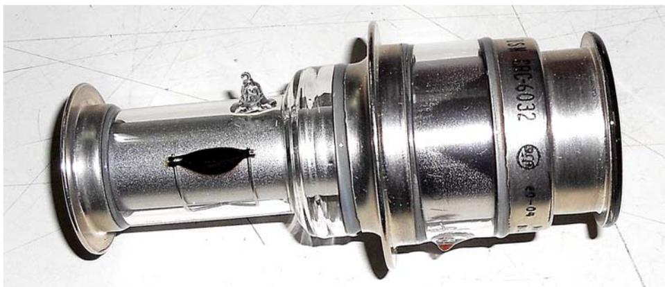
Il convertitore d'immagine CRC-6032A-RCA. A destra di chi guarda vi è il catodo fotoemittente, al centro, l'anello della griglia focalizzatrice, alla sinistra, lo schermo a fosfori verdi da 5/8 di pollice. La lunghezza del tubo è di circa 11,5 cm. Il diametro del fotocatodo è di circa 3 cm
