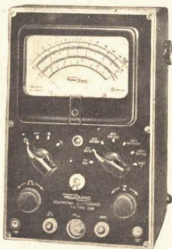
21140 VOLTMETRO ELETTRONICO. Serie TV tipo 104 - portate da 1 a 1.000 Volta c.c. e c.a. in 7 portate - sonda per la tensione alternata e R.F. con doppio diodo per l'autocompensazione. Ohmetro da 1 Ohms a 1.000 Megaohms, suddiviso in 6 portate (10 Megaohms centro scala), scala zero centrale. Dimensioni mm. 240 x 160 x 140. L. ....
