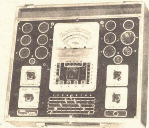
21180 TESTER PROVAVALVOLE P.V. 20 D. Possibilità di esame di tutte le valvole europee ed americane correnti, regolazione di rete, selettori a leva, prova c.c. Analizzatore incorporato ad ampio quadrante - 5.000 Ohms per Volta in c.c. e 1.000 Ohms per Volta in c.a. - 2 scale Ohmetriche indipendenti 1.000 Ohms e 3 Megaohms inizio scala. Dimensioni mm. 390 x 330 x 130. L. ....
