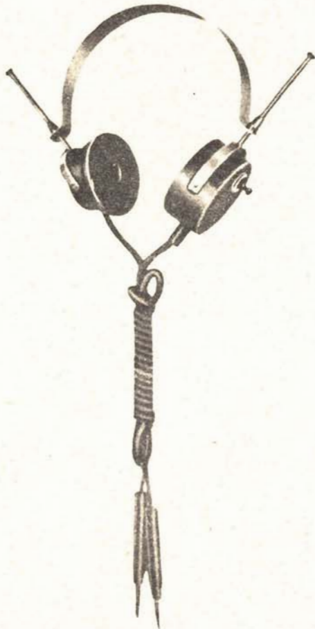
01730 CUFFIA PROVA CIRCUITO completa di condensatore 1 MF, interruttore, puntali con manicotto isolante. Resistenza del ricevitore 150 Ohms. L. ....
