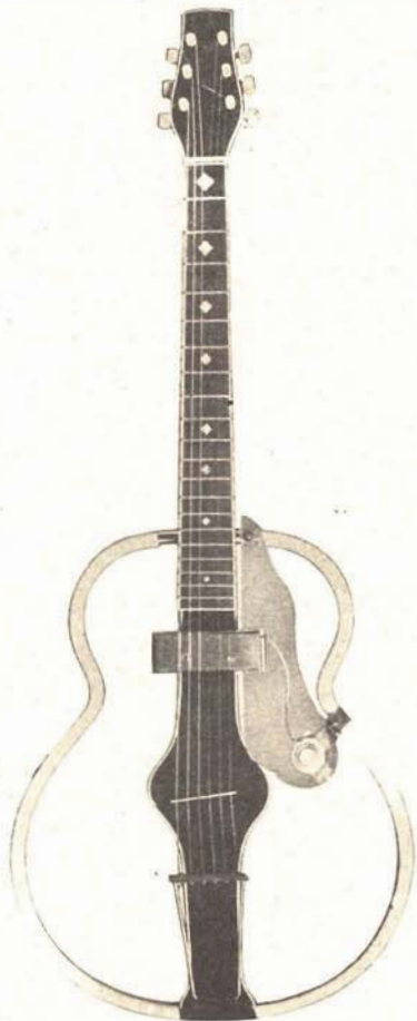
19220 CHITARRA ELETTRICA VAAM « Vibropik » brevetto n. 1830, senza cassa armonica. Sfrutta la sola vibrazione meccanica delle corde. Risponso acustico di altissima fedeltà fino a frequenze di 60-70 periodi. L. ....
