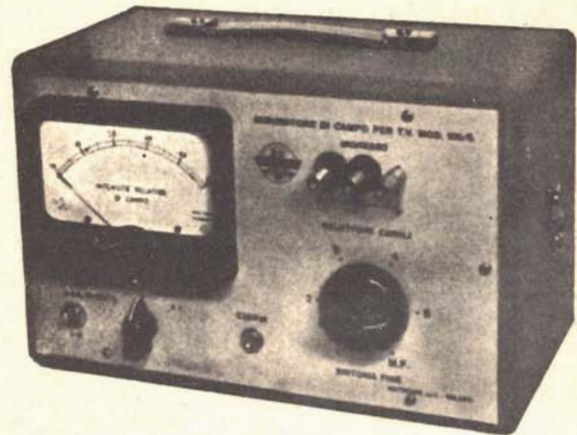
21260 MISURATORE DI CAMPO PER TV mod. 105/S. Campo di misura: 5 canali TV più un canale F.M. Sensibilità: da 5 \mu V. a 50.000 \mu V. Portate: 4 portate corrispondenti a 50, 500, 5000, 50.000 \mu V. fondo scala. Impedenza d'ingresso: 75 Ohms sbilanciata e 300 Ohms bilanciata. Alimentazione: 50 Hz - 110 - 125 - 145 - 160 - 220 - 280 Volta. Dimensioni mm. 160 x 190 x 310. L. ....
