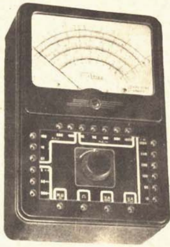
21100 ANALIZZATORE T. C. 18 D - 22 portate. Strumento a bobina mobile e magnete permanente; 10.000 Ohms per Volta c.c. e 1.000 Ohms c.a. - dimensioni mm. 195 x 130 x 80. Completo di puntali. L. ....
