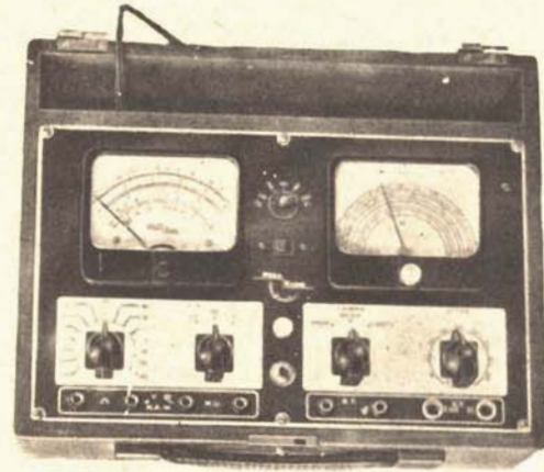
21160 COMPLESSO ANALIZZATORE OSCILLATORE « COMBINAT ». Analizzatore 10.000 Ohms per Volta c.c. e 1.000 Ohms per Volta c.a. - Ohmetro a 3 portate indipendenti: 500, 50.000 Ohms, 5 Megaohms inizio scala. Oscillatore a lettura diretta in frequenza e in metri da 165 kHz a 20 MHz. Dimensioni mm. 300 x 230 x 110. L. ....
