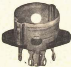
7060 ZOCCOLO RIMLOCK, da incassare, per valvole europee, 8 piedini, in tangendelta e metallo, interasse fori di fissaggio mm. 28,6. L. ....
