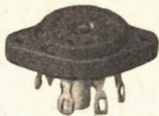
ZOCCOLI MINIATURA da incassare, per valvole americane, 7 piedini 7020 in ceramica normale, interasse fori di fissaggio mm. 22,4. L. .... 7040 in ceramica, interasse fori di fissaggio mm. 28,6. L. ....
