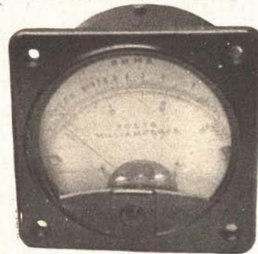
20880 MILLIAMPEROMETRI VAAM DA QUADRO con scala tester, per corrente continua, sistema a magnete permanente e bobina mobile, flangia mm. 73, dia-
