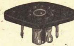
7100 ZOCCOLO NOVAL, da incassare, per valvole europee, 9 piedini, in tangendelta, interasse fori di fissaggio mm. 28,6. L. ....
