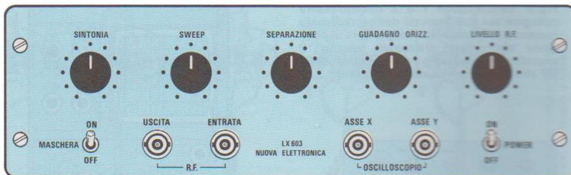
Fig. 7 Ecco il pannello frontale del mobile dello sweep, il potenziometro di sinistra della SINTONIA permette di portare al centro scala dell'oscilloscopio la curva campione a 455 KHz.
