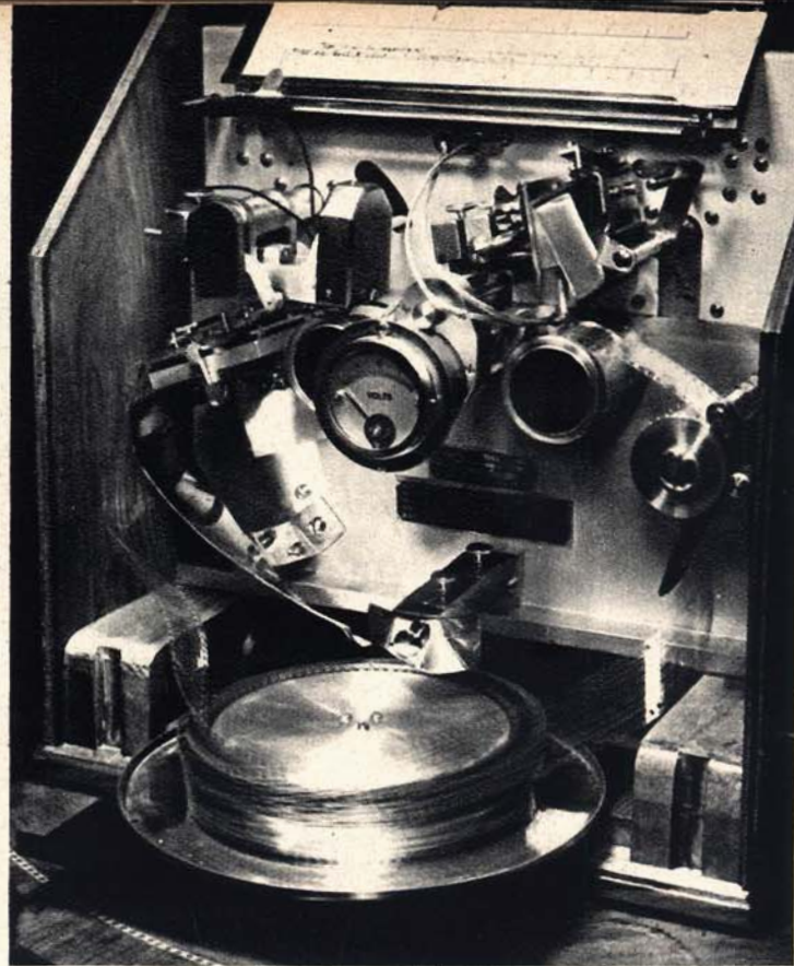
Il Tephiphon permette di avere, senza interruzione, una riproduzione fino a 24 ore di durata. La fotografia lo mostra aperto: si vede la scala che indica quale delle incisioni venga registrata e permette quindi una rapida scelta del brano da riprodurre. Inoltre, al disopra del voltmetro, si scorge l'apparecchio incisore; a sinistra ed a destra quello riproduttore. La pellicola è senza fine.
