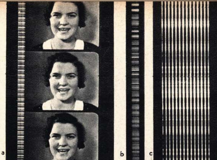
a. Pellicola normale per cinematografia sonora; b. Pellicola con incisione del suono (sistema Klangfilm); c. L'incisione del suono (sistema Klangfilm)
