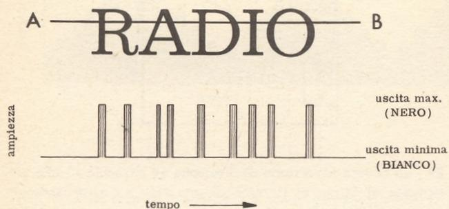
Fig. 26 - Se, invece, il segnale di ampiezza massima è ottenuto in seguito alla lettura delle zone nere, si ha modulazione negativa (sistema adottato in Italia). Si noti che, a parte il rovesciamento, il segnale presenta la stessa forma.
