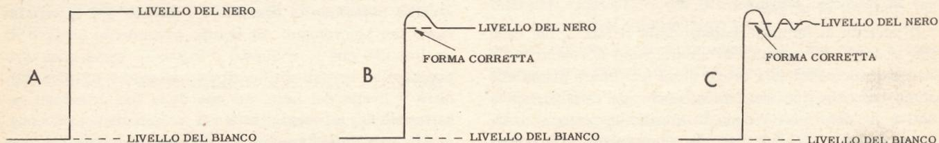
Fig. 39 - Le brusche variazioni di livello che possono verificarsi durante la scansione per un passaggio — come in A — da un particolare di massimo bianco ad uno di massimo nero, oltre che apportare distorsione per ritardo possono dar luogo ad una alterazione per eccesso (come in B) o ad un'emissione di oscillazioni spurie (come in C).
