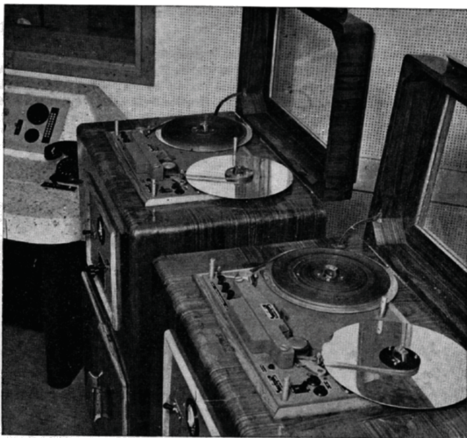
Fig. 12.19. - Registratori magnetici a nastro usati dalla Radio Italiana per le registrazioni da studio. Velocità del nastro: 38,1 cm/sec, oppure 76,2 cm/sec. Gamma acustica da 50 a 10.000 sino a 15.000 c/s, più o meno un decibel. Dinamica di registrazione di 50 dB. Questi apparecchi superano in perfezione qualsiasi altro sistema di registrazione attualmente esistente, compreso il film sonoro. I radioascoltatori non hanno la possibilità di distinguere tra un programma musicale diretto ed uno registrato, al contrario di quanto avviene per i dischi. A seconda delle dimensioni, le bobine consentono registrazioni da 20 a 35 minuti, senza interruzione.
