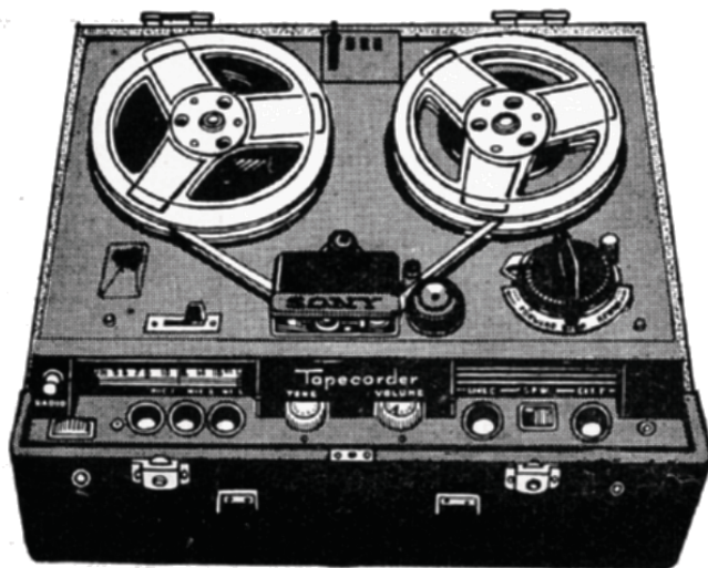
Fig. 12.10. - Il nastro magnetico passa dalla bobina di sinistra a quella di destra, scorrendo sopra la testina magnetica di registrazione/riproduzione. (Registratore Sony).
