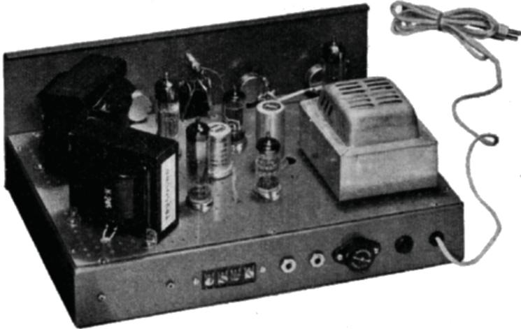
Fig. 9.40. — Aspetto del telaio con i componenti dell'amplificatore di fig. 9.38.
