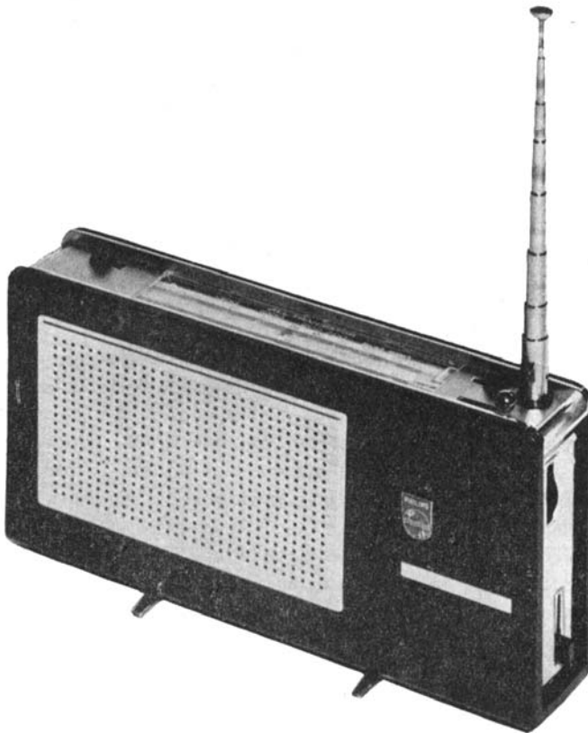
Fig. 14.1. - Apparecchio per onde medie e due gamme di onde corte, con antenna in ferrite per le OM e antenna telescopica per le OC. (Philips mod. L2XL5T).
