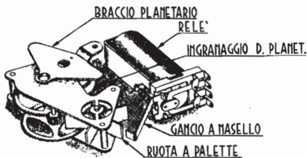
Fig. 12.2 - Aspetto d'insieme del meccanismo di ricerca automatica delle emittenti. È del tipo a molla e elettromagnete.
