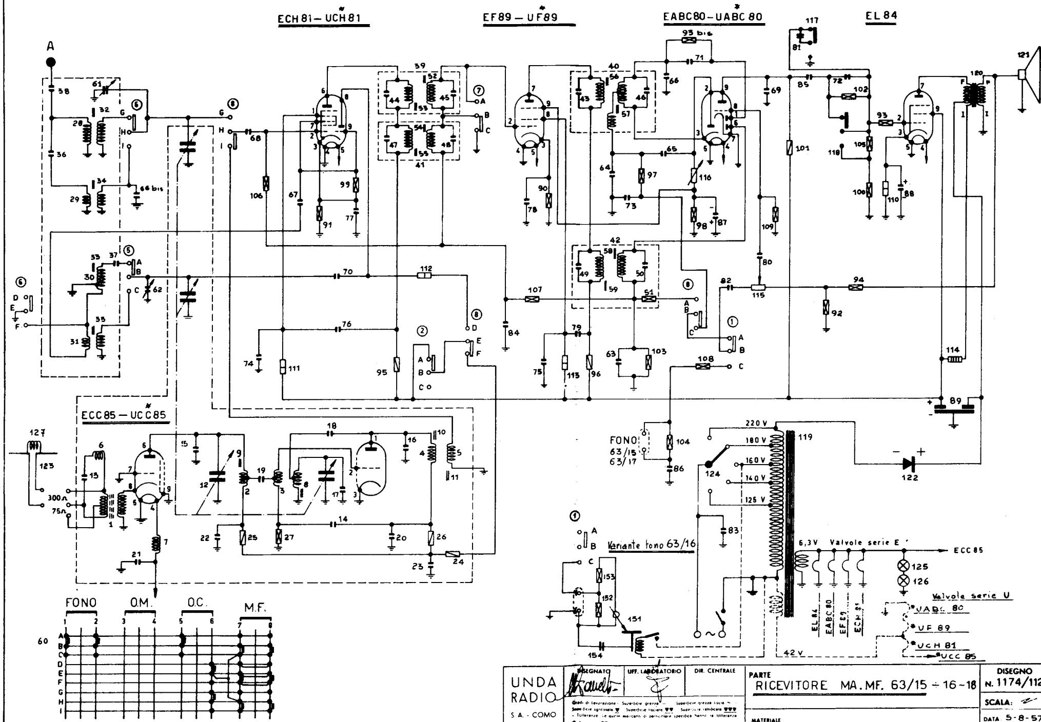
**UNDA RADIO - Modd. 63/15-16-18.** Apparecchi a modulazione d'ampiezza e di frequenza. Tre gamme d'onda: OM da 182 a 580 m, OC da 17 a 52 m e OUC da 87 e 100 Mc/s. Medie frequenze a 467 kc/s e a 10,7 Mc/s. Commutazione a quattro tasti. Regolatori per gli acuti e i bassi. Dipolo incorporato. Potenza 3 watt.
