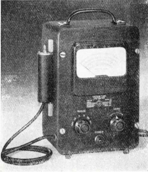
FIG. 11 - Voltmetro elettronico 1803-A di produzione General Radio Co. Si osservi la testa adattata lateralmente alla cassetta dello strumento.
