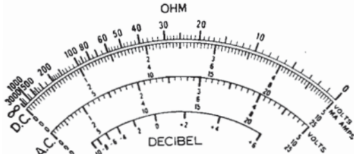
FIG. 3 - Scala multipla dello strumento di fig. 2.
