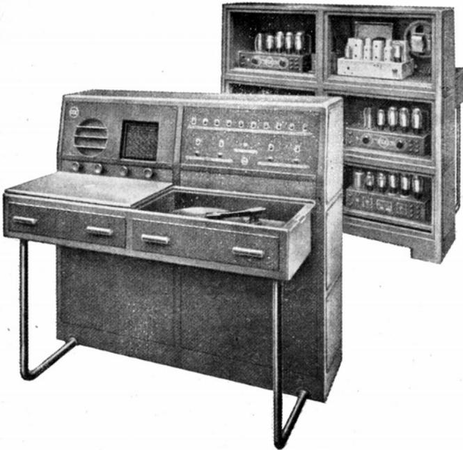
FIG. 3 - Centralino di distribuzione C.G.E. tipo «scrivania», per potenze modulate da 70 a 300 W.
