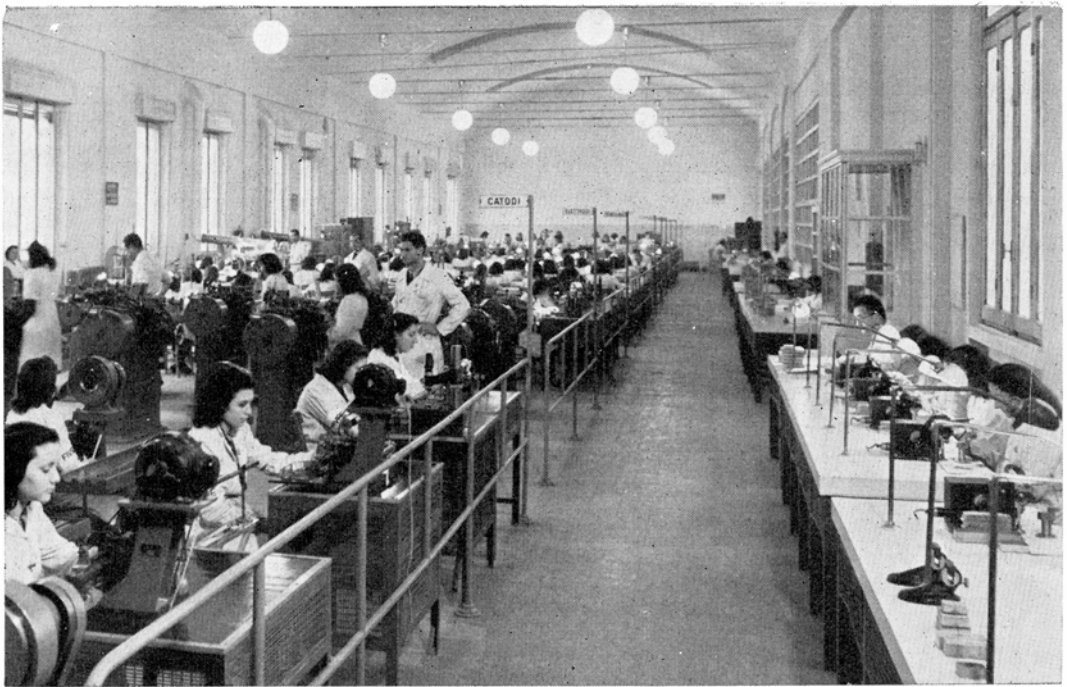
Fig. 6 - Reparto catodi e filamenti di uno stabilimento F.I.V.R.E.
