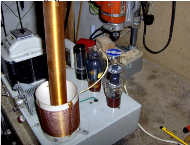
Parte superiore con le due 807 e la 5U4.
