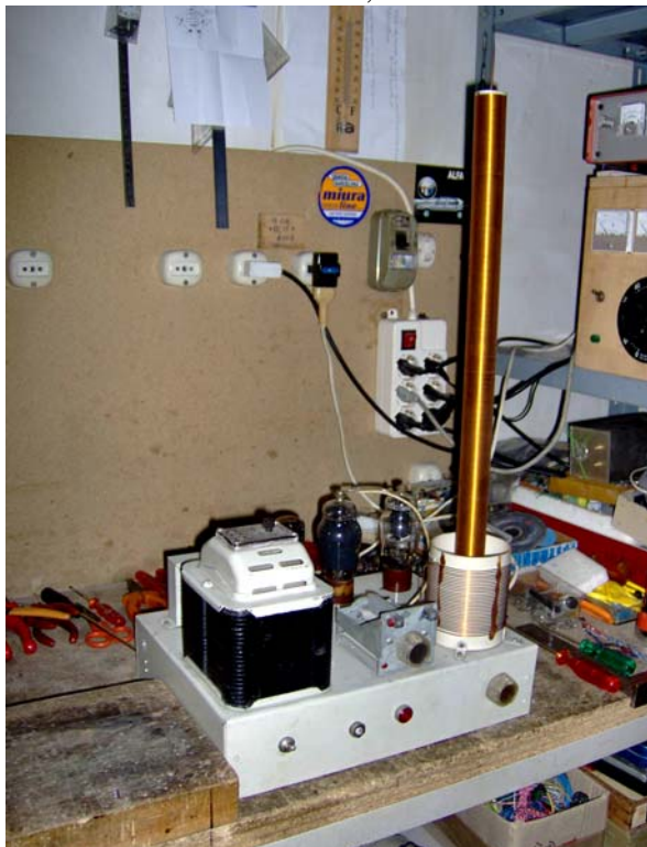
Il pesante trasformatore, recuperato da un televisore IMCA
