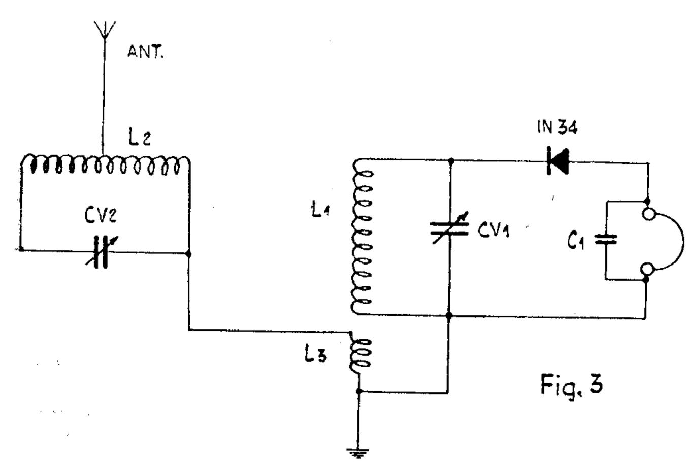
ranno per eliminare la stazione disturbatrice. Anche L2 avrà ogni 30 spire una presa a boccola in modo da poterne sfruttare tutte le possibilità per ottenere sensibilità o selettività.
