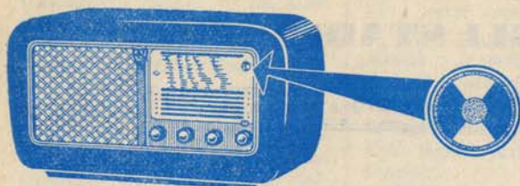
Fig. 2. — Pure con l'ausilio dell'occhio magico sarà possibile stabilire quale degli stadi risulti in difetto. Se agendo sul comando di sintonia l'occhio magico si restringe senza che alcun suono si registri in altoparlante, stabiliremo essere in difetto lo stadio di BF; in caso contrario il difetto dovrà ricercarsi negli stadi di AF e MF.
