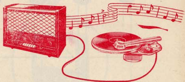
Fig. 1. — Commutato il ricevitore in posizione FONO e inserito nella presa stessa un segnale di pick-up (fonorivelatore), ammesso che detto segnale venga riprodotto in altoparlante, il difetto dovrà essere ricercato negli stadi di AF e MF; in caso contrario, il difetto sarà da addebitare a quello di BF.
