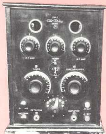
Ecco un vecchio ricevitore a reazione. Questi apparecchi irradiavano tanta energia RF che si potevano sentire anche in altri ricevitori.
