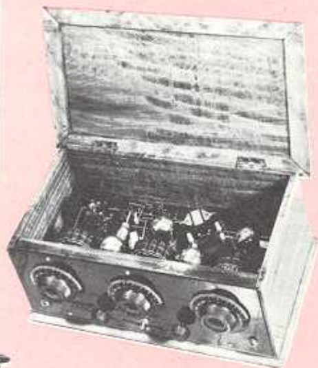
Questa è la scatola di montaggio del ricevitore Freshman, che fu presentata nel 1924 con immensa gioia di tutti i dilettanti dell'epoca. Si trattava di un ricevitore a cinque tubi accordati: per la ricezione si dovevano sintonizzare tutte e tre le manopole.
