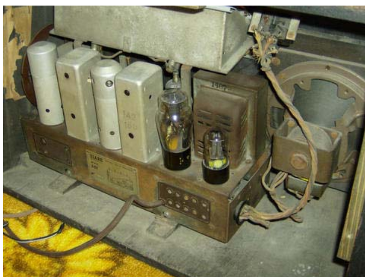
Vista interna di una radio Siare mod. 501 (anno 1941). Si notino le valvole tipo Octal e l'altoparlante elettrodinamico
