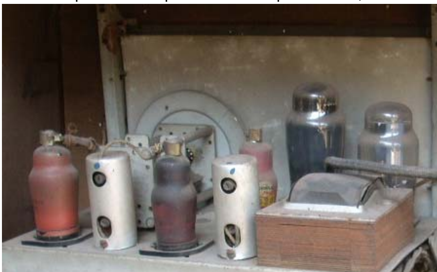
Vista interna di una radio Phonola con valvole "a vaschetta", buona base per un restauro.
