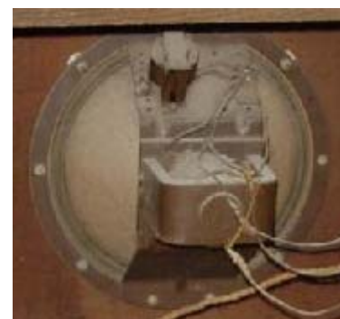
Altoparlante elettrodinamico, con bobina di campo.
