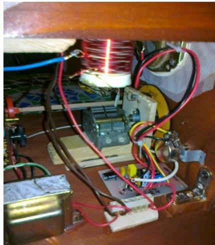
Il sintonizzatore FM l'ho reperito da una non giovane radio a transistor, che ho dovuto montare nello stesso mobile utilizzando per il comando della sintonia un semplice e funzionale asse (listello circolare di legno) imperniato con il variabile della sintonia. Come si può vedere dalla foto, il tutto funziona molto bene, anche se nella ricerca, si sente la mancanza di una demoltiplica.
