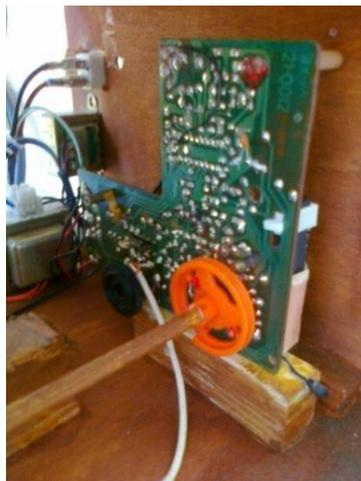
Il sintonizzatore di cui ho utilizzato solo la parte di AF
