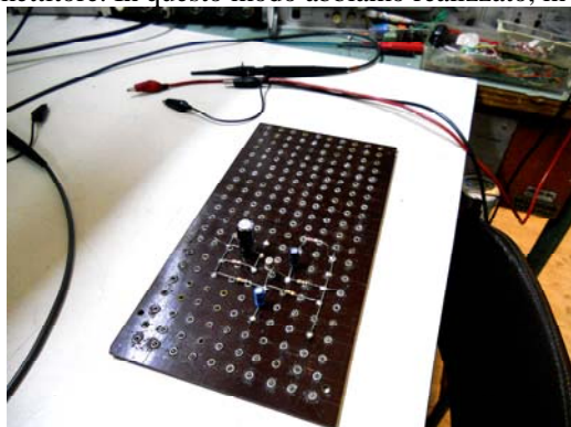
Il circuito montato su basetta rivettata, modificato come in Fig.06 ...
