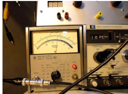
Tensione d'uscita su -3dB a 66Hz
