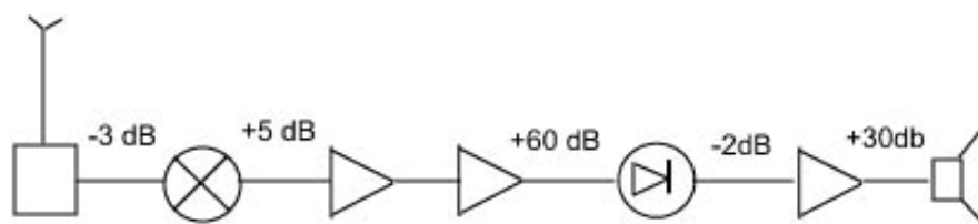
filtra di antenna convertitore amplificazione IF rivelatore amplif. BF
