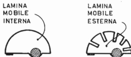
*Normalmente le due lamine mobili estreme di un condensatore variabile sono dotate di intagli radiali; su questi intagli si agisce meccanicamente, per mezzo di un cacciavite, per ottenere un corretto allineamento delle emittenti nella posizione di centro-scala.*
