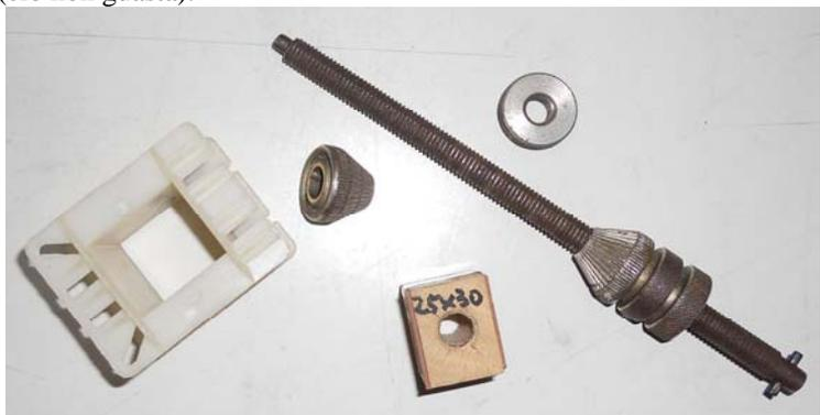
Il cartoccio in plastica, il "tacco 25X30", l'asse di trascinamento con i cunei e i bottoni di serraggio.
