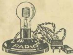
Consiste in un'ampolla a gas ionizzato (la lampada al neon) che viene inserita in serie al filamento da verificare. Se il filamento è intero, una luce rossiccia si produce nella lampada che, viceversa, rimane spenta se il filamento è interrotto.
