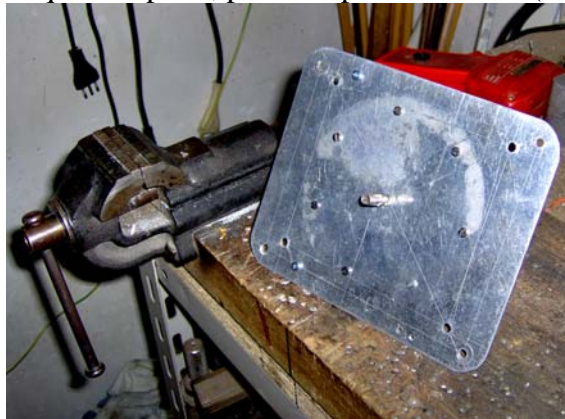
1) Nella parte sottostante della piastra si nota il perno di fissaggio alla morsa
