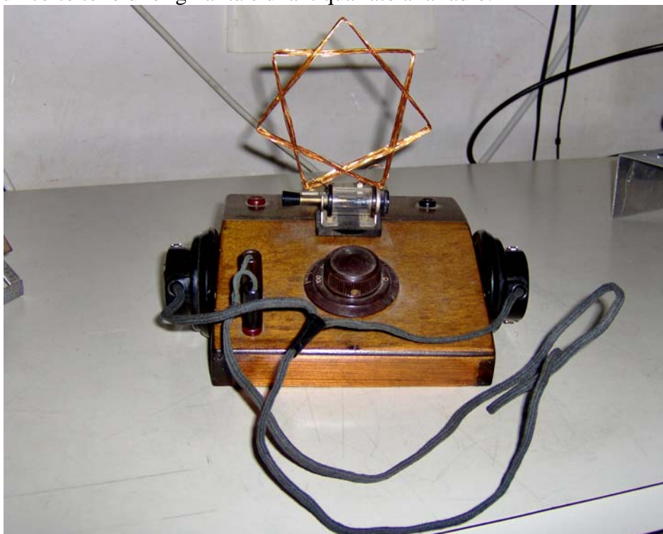
8) La bobina montata sulla radio a galena
