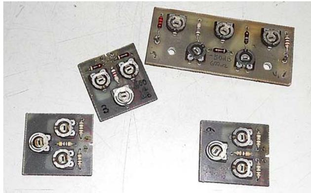
Alcune vecchie piastrelle attenuatrici a "T", utilizzate per attenuare un segnale di 50 dB, 6dB e 3dB su  $600\Omega$ . Si notano i trimmer di taratura dei rami serie e parallelo, per ottenere un valore molto preciso dell'attenuazione.
