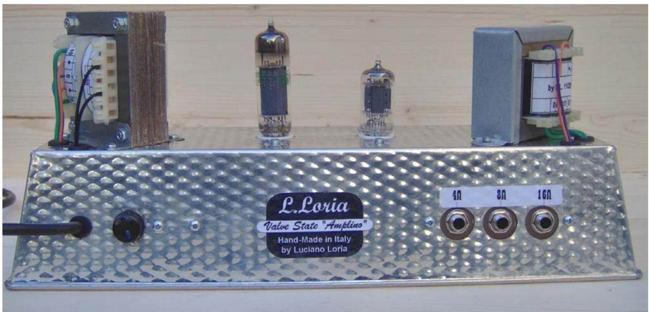
Per il momento lo strumento è stato requisito dal chitarrista di casa (mio figlio), lo tiene in ostaggio fino a quando non completerò il "combo" valvolare che ho promesso di costruirgli da tempo, si tratta di un amplificatore da 15 Watt circa d'uscita, che utilizza ancora una coppia di EL84 in configurazione Push-Pull classe AB1, se son rose fioriranno, anche sul sito...
