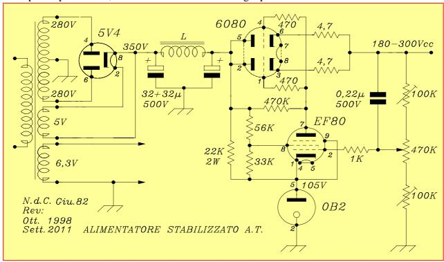
Lo schema è semplice e ricalca i circuiti standard di questo tipo. Vi è un robusto alimentatore che fornisce una tensione di circa 350Vcc al circuito di regolazione in serie. La raddrizzatrice è una 5V4 che può erogare una corrente *Imax*=175mA.
