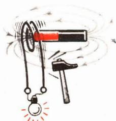
Se, invece di far oscillare il magnete, facciamo oscillare le spire, dando la martellata a queste, che supponiamo formate con metallo conduttore elastico, l'effetto è identico.
