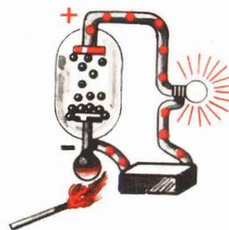
Esagerando, si potrebbe dire che una lampadina inserita nel circuito giungerebbe ad accendersi per effetto dell'aumento di tensione dato dal flusso elettronico attraverso il conduttore anodico. Così l'energia termica della fiamma si trasformerebbe direttamente in energia elettrica, per quanto, praticamente, in minima parte.
